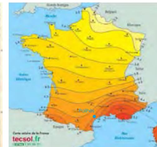
moyennes annuelles de l'énergie reçue sur une surface orientée au Sud et inclinée d'un angle égal à la latitude (en kWh/m<sup>2</sup>.jour).
